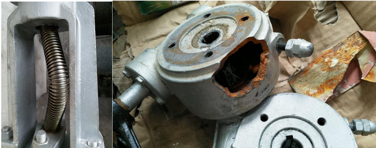
Uszkodzenie trzpienia zasuwki klinowej i przekładni spowodowane elementem stalowym który utknął pomiędzy klinem zasuwki i korpusem. Obsługa próbowała zamknąć za wszelką cenę zasuwę przy użyciu 2 metrowego klucza typu „F”
