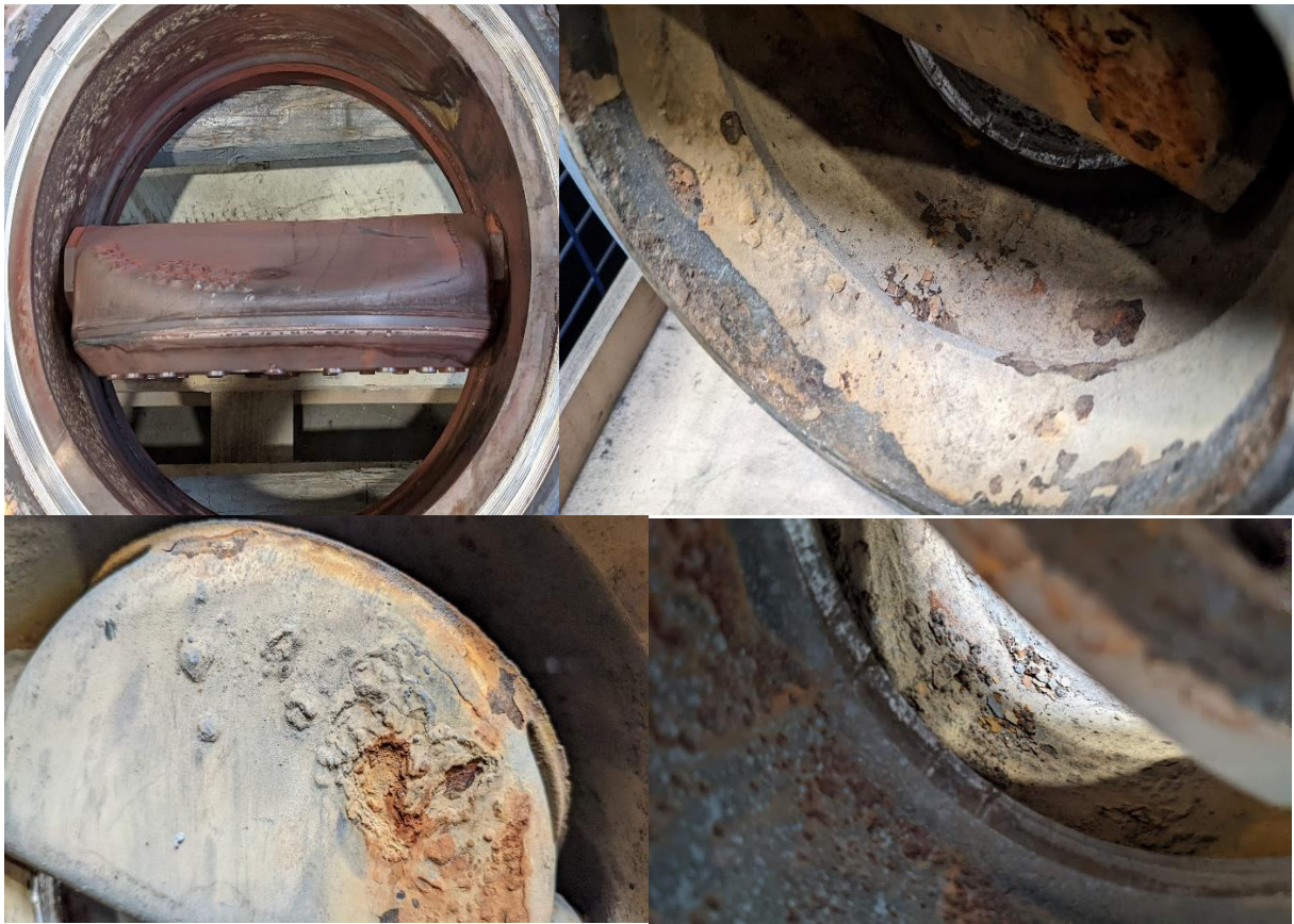
Uszkodzenia przepustnicy pracującej na rurociągu pary spowodowane kamieniem kotłowym.
