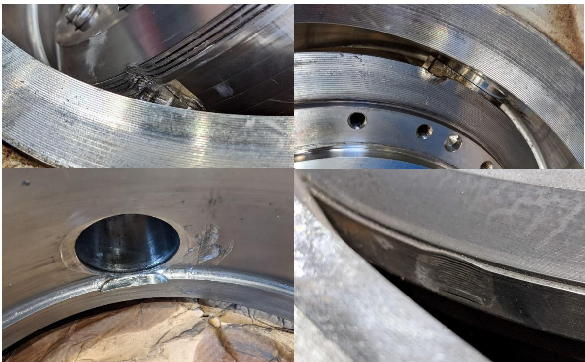
Uszkodzenia elementów przepustnicy elementem metalowym
