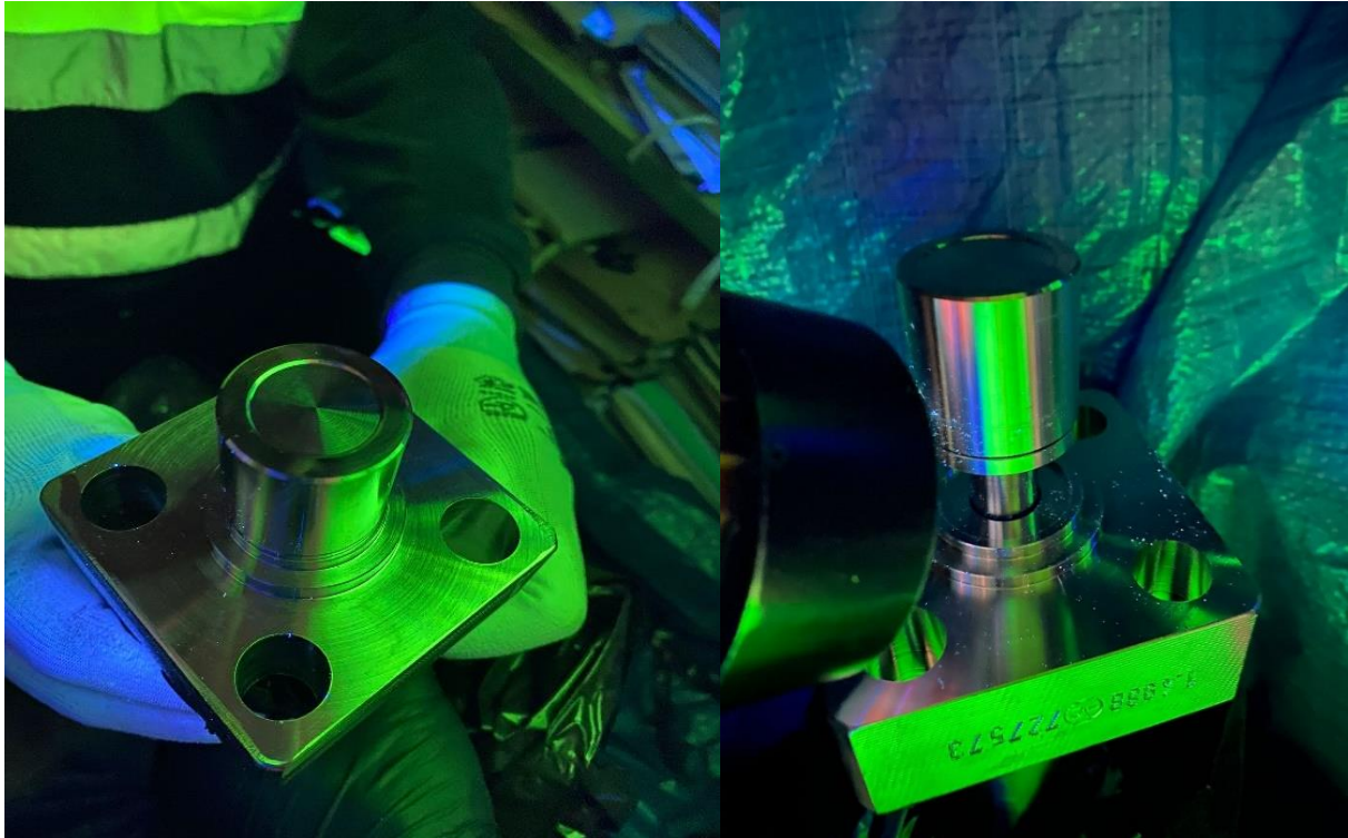
Pokrywa z grzybkiem z zaworu – przygotowanie do czyszczenia instalacji
